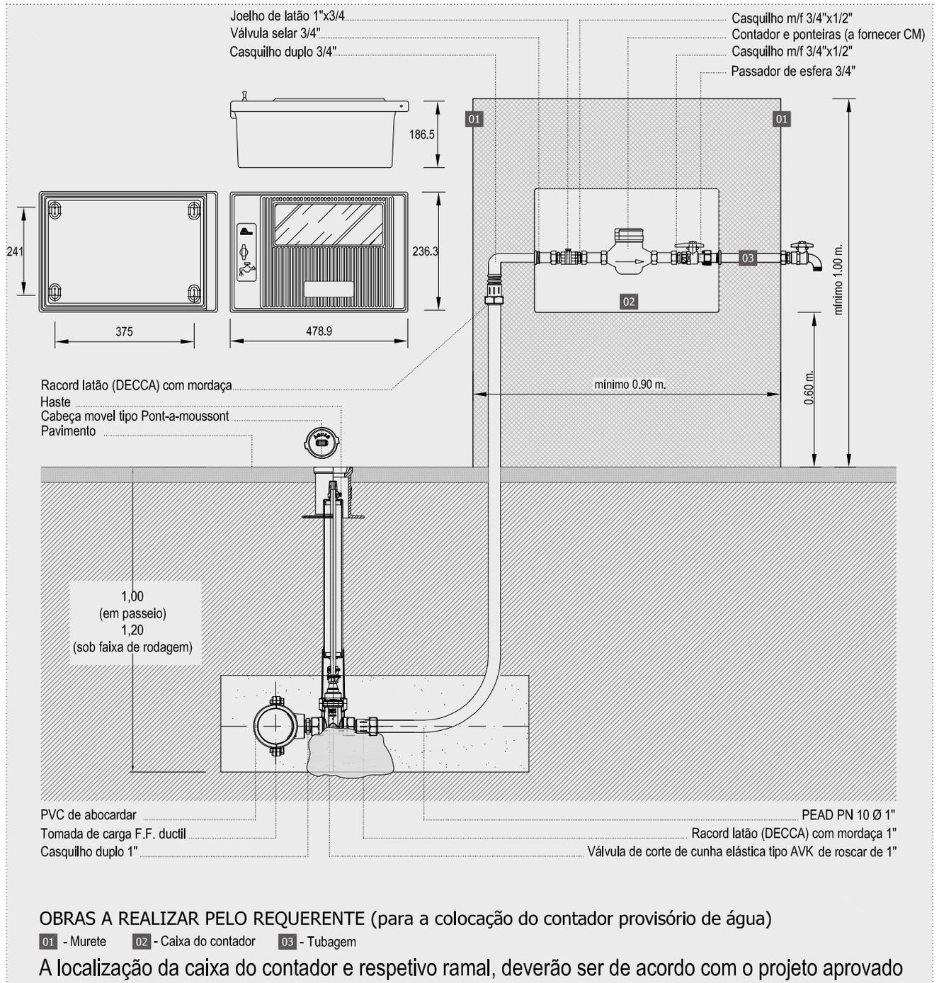
OBRAS A REALIZAR PELO REQUERENTE (para a colocação do contador provisório de água)
